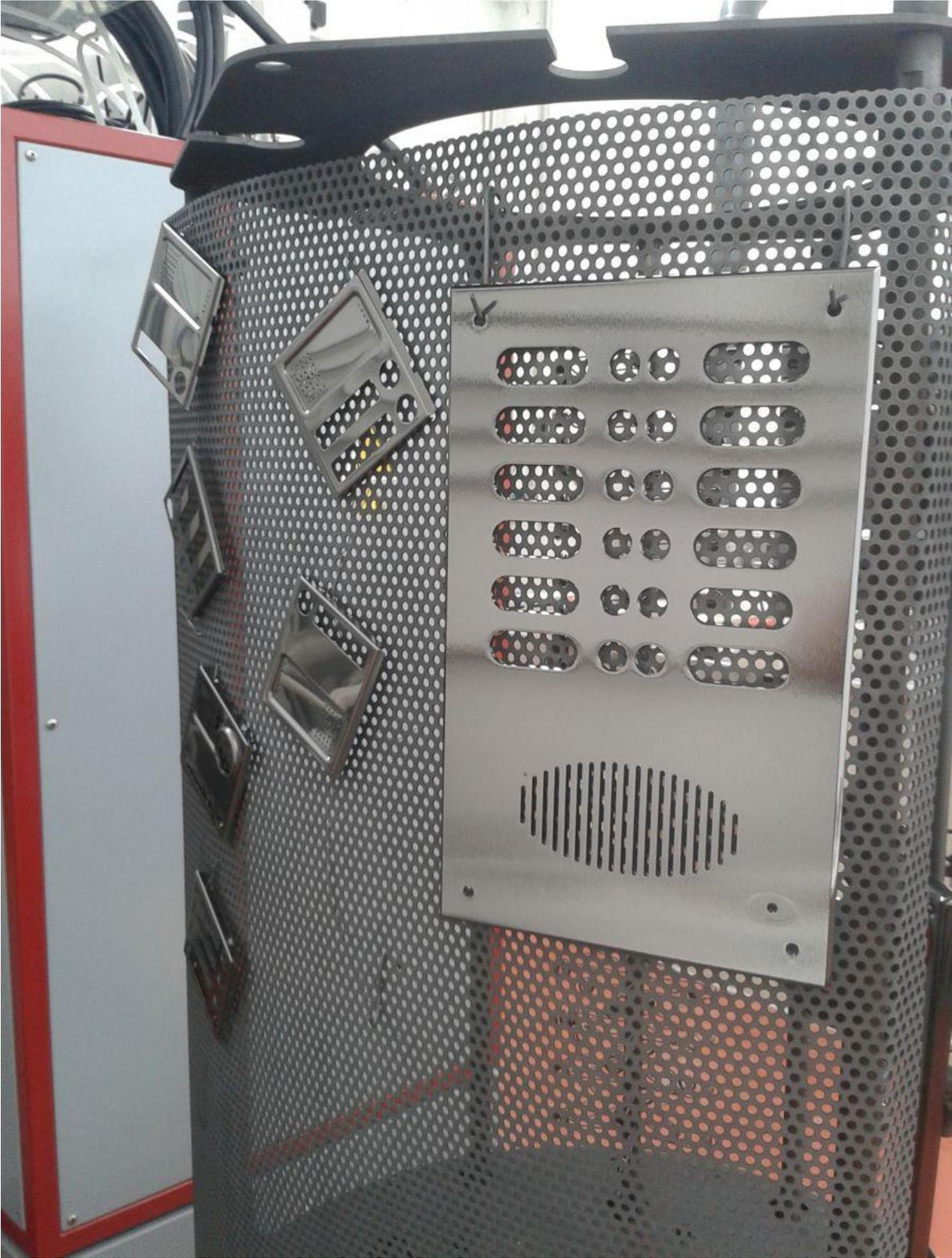
Le PVD (« physical vapor deposition », ou dépôt physique en phase vapeur) est un procédé de traitement de surface emprunté à l'industrie. Il s'agit d'un procédé de métallisation : il permet de produire une vapeur métallique pouvant être déposée sur la surface des pièces à revêtir, sous la forme d'une, ou plusieurs, fine couche de métal pur ou d'alliage.
